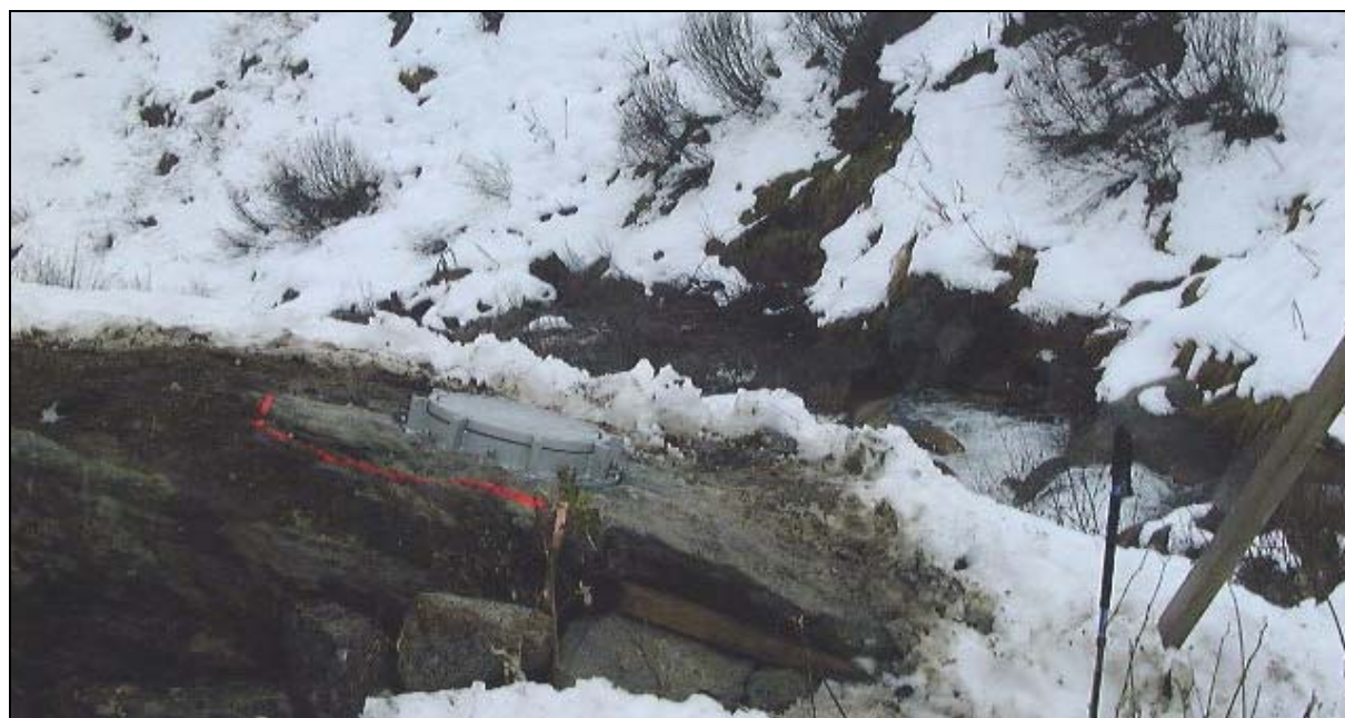
Abbildung: Der Kombisensor wird am Rande eines Murganggrabens auf eine Felsplatte montiert. Die Zuführung der Speisungs- und Signalkabel erfolgt durch den Fels. Das Sensorgehäuse ist zum Schutz vor Blitzschäden lokal geerdet.
